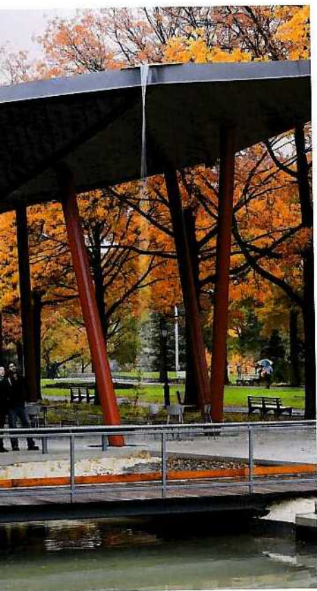
Павильон в Ботаническом саду в Квинсе. Форма крыши позволяет собирать дождевую воду, которая стекает в накопительный бассейн, очищается и по каналам подается в фонтан у входа в сад. Потребление воды сокращено на 30 %.
